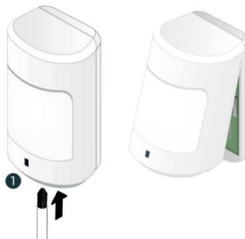
Рисунок 6.2 – Вскрытие корпуса датчика
