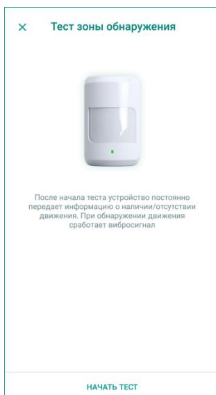
Рисунок 12.3 – Тест зоны обнаружения (начало)
